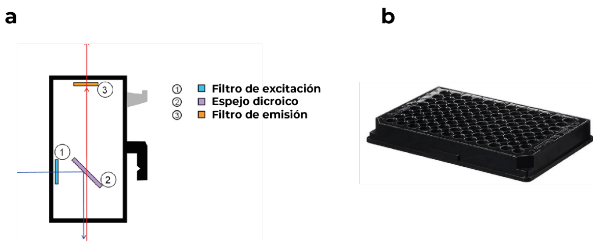
Figura 3.3. a) representación del módulo óptico utilizado para medir intensidad de fluorescencia en lector de placas. b) Placa genérica opaca para medir fluorescencia.
